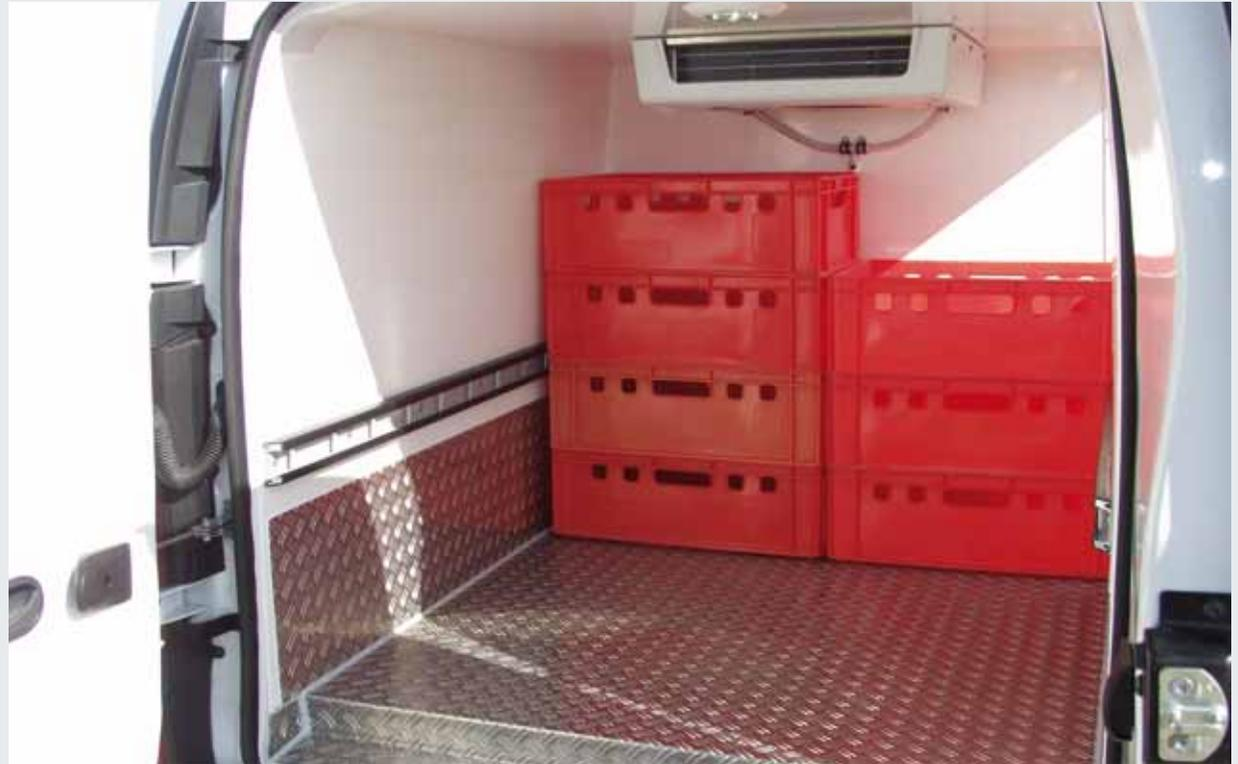
Druckentlüftung für den Laderaum gehört ebenso zur Serienausstattung, wie das Bedienelement für die Kühlanlage mit digitaler Temperaturanzeige im Fahrerhaus und die TÜV-Abnahme.
